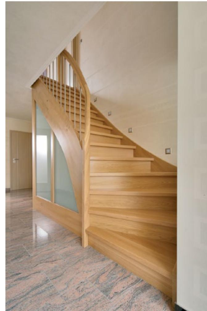
◀ COMFORTLINE in Kernesche durchgehende Lamelle blockverleimt. Oberfläche 3-fach lackiert, ausgestattet mit Wangen und Handlaufkrümmung, Stäbe aus Edelstahl gefertigt, Verkleidung des Kellerabgangs als Holz-Glas-Element mit satinierten Glasscheiben
