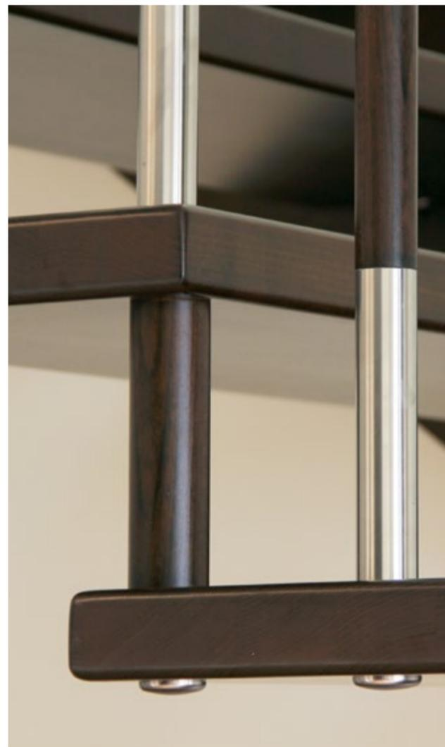
*STANDARDLINE in Holzart Buche durchgehende Lamelle blockverleimt, Oberfläche gebeizt und lackiert, Stäbe als Holz-Edelstahl-Kombination E2, Tragbolzen Buche gebeizt, Handlaufausführung mit Krümmung, Pfosten 90 x 90 mm mit dekorativen Dachschnitt und Kehle, ST038*
