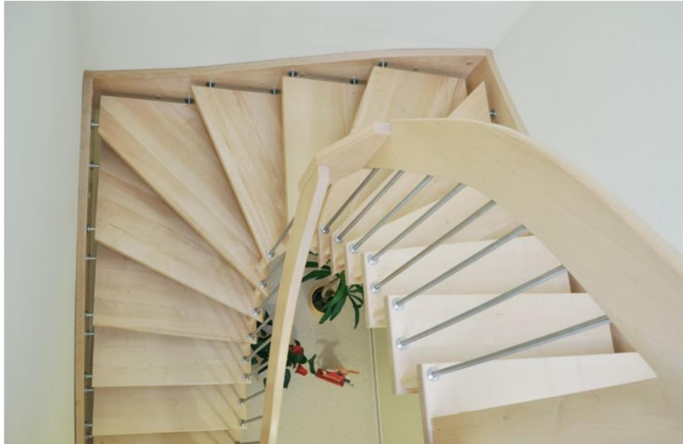
*STANDARDLINE in Holzart Buche durchgehende Lamelle blockverleimt, Stäbe in Edelstahl und Tragbolzen aus Buche gefertigt, Ausführung der Handläufe in geschwungener Form, Wandwange in gebolzter Ausführung, ST020*
