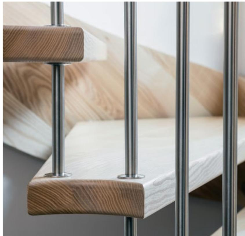
*STANDARDLINE in Holzart Esche MB, Stäbe und Tragbolzen aus Edelstahl gefertigt, die Stufen wurden wandseitig schalldämmend in die Wange gebolzt, Ausführung des Handlaufes als Handlaufkrümmung, Oberfläche umweltfreundlich geölt*
